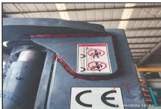
APLICACIÓN DE PENETRANTE A ZONA DE INSPECCIÓN
