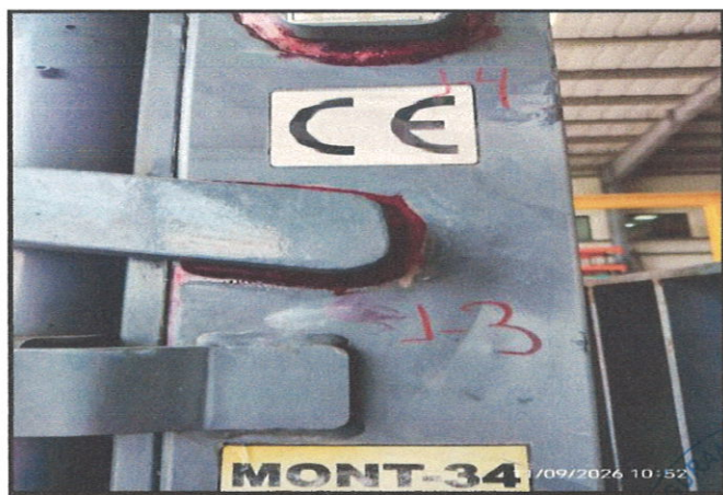
APLICACIÓN DE PENETRANTE A ZONA DE INSPECCIÓN
