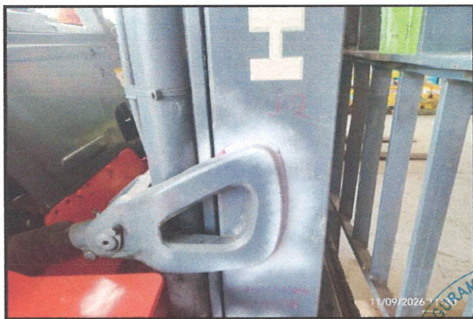
APLICACIÓN DE REVELADOR A ZONA DE INSPECCIÓN
