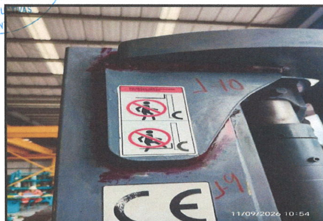
APLICACIÓN DE PENETRANTE A ZONA DE INSPECCIÓN
