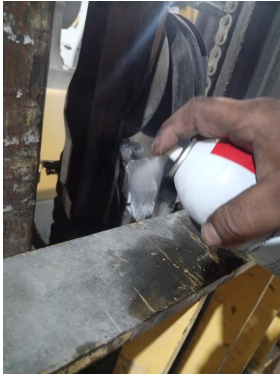
LUBRICADO DE CADENAS
