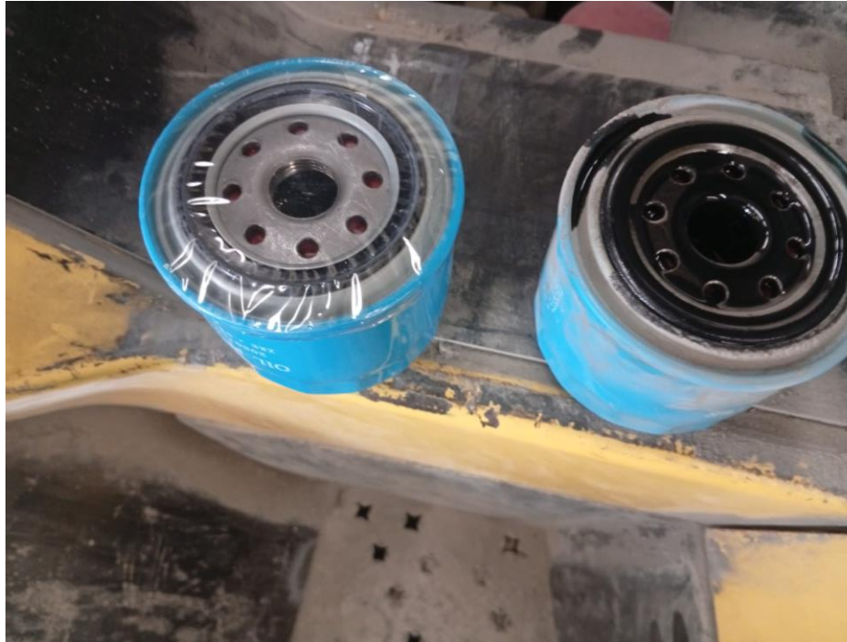
REEMPLAZO DE FILTRO DE ACEITE
