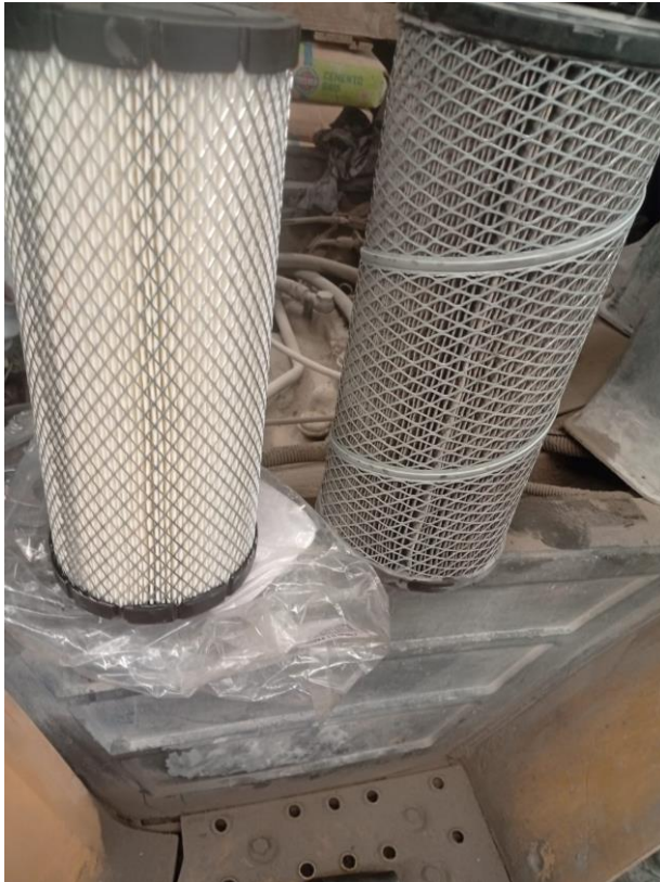
REEMPLAZO DE FILTRO DE AIRE PRIMARIO
