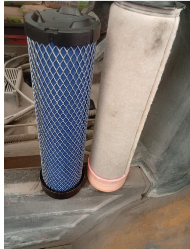
REEMPLAZO DE FILTRO DE AIRE SECUNDARIO
