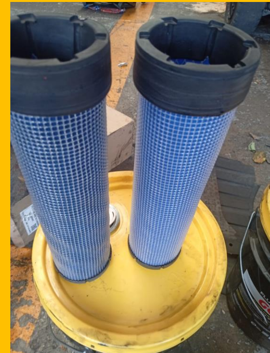
REEMPLAZO DE FILTRO DE AIRE PRIMARIO Y SECUNDARIO
