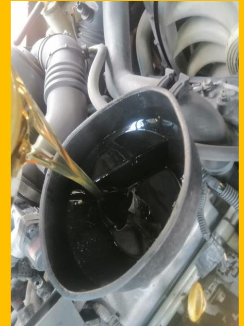
SUMINISTRO DE ACEITE DE MOTOR
