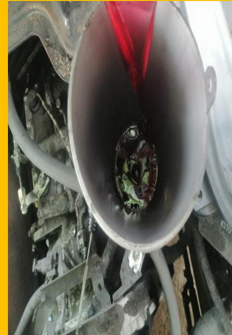
SUMINISTRO DE ACEITE DE TRANSMISIÓN
