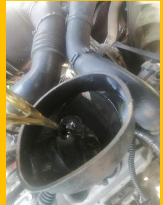
SUMINISTRO DE ACEITE DE MOTOR
