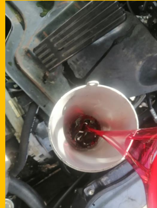
SUMINISTRO DE ACEITE DE TRANSMISIÓN
