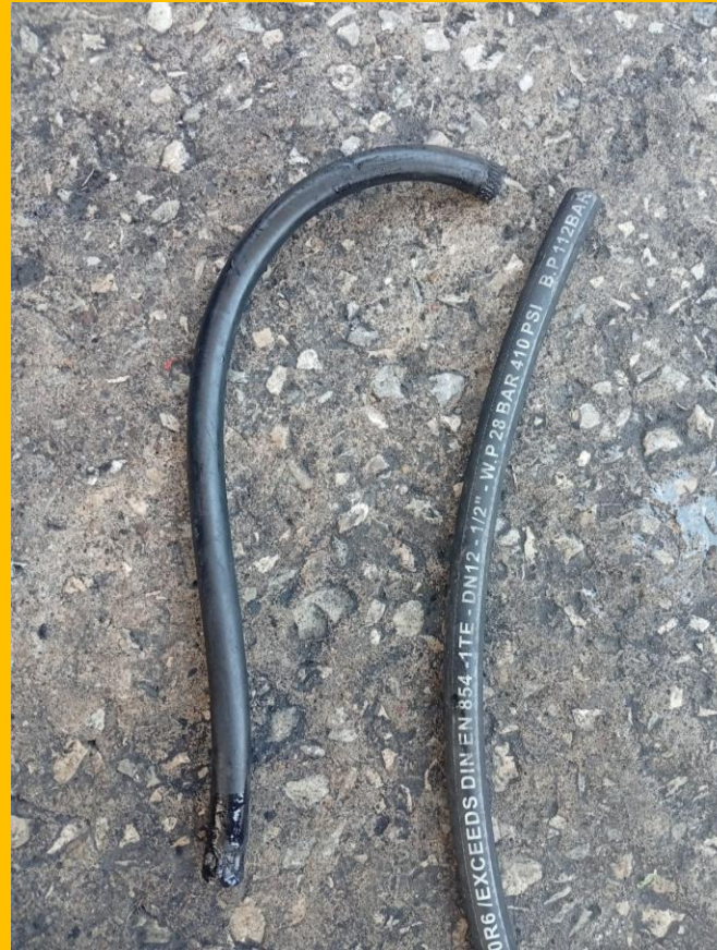
COMPARACIÓN DE MANGUERA DE ENFRIADOR DE ACEITE DAÑADA Y NUEVA
