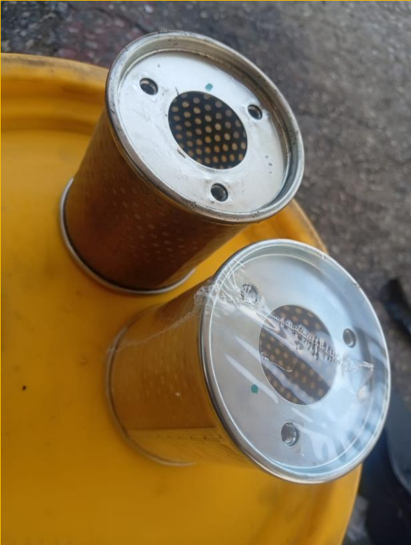
REEMPLAZO DE FILTRO HIDRAULICO DE SUCCION
