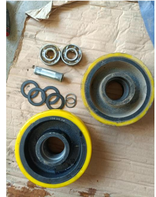
RUEDA Y ACCESORIOS NUEVOS (IZQ.) RUEDA Y ACCESORIOS DESGASTADOS (DER.)
