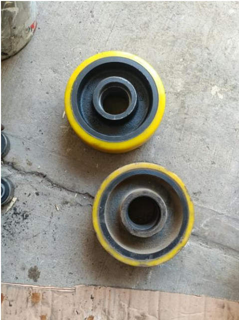
SE OBSERVA LA DIFERENCIA DE RUEDA
