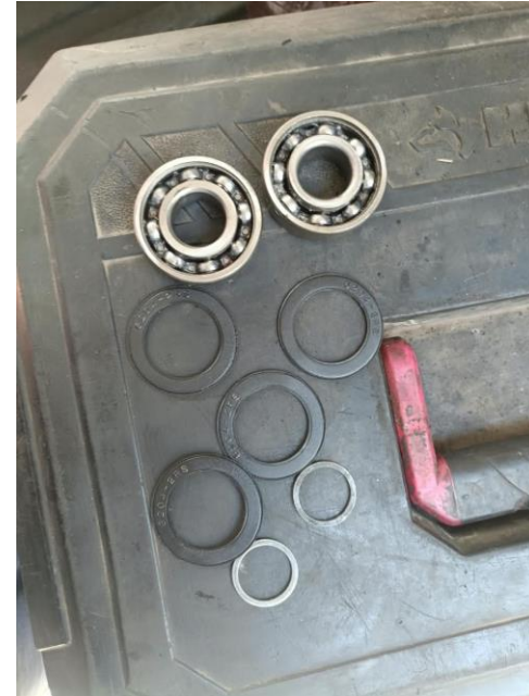
BALEROS DE RUEDA: DESPUÉS DE LIMPIEZA Y ENGRASADO
