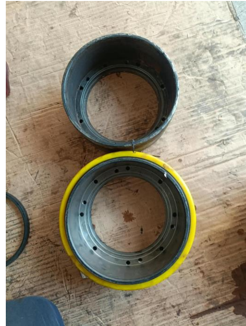
EXTRACCIÓN DE RUEDA DE DIRECCIÓN Y BALERO DAÑADOS
