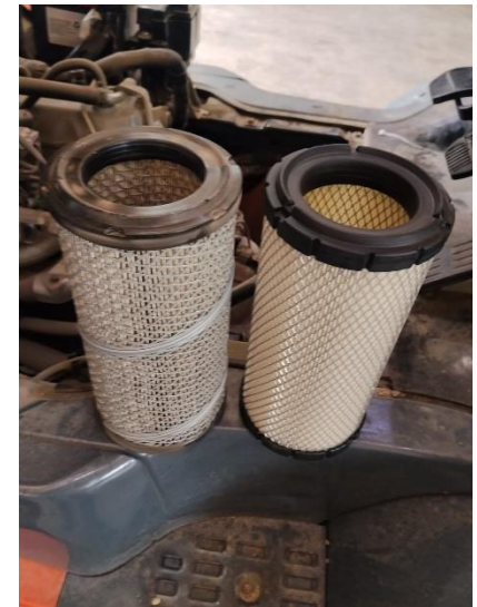
FILTROS DE AIRE, ANTERIOR (IZQ) NUEVO (DER)
