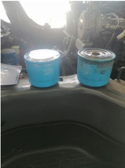
FILTRO DE ACEITE DE MOTOR NUEVO (IZQ) FILTRO ANTERIOR (DER)
