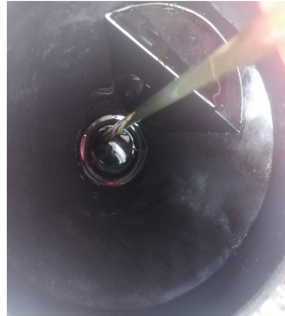
SUMINISTRO DE ACEITE NUEVO
