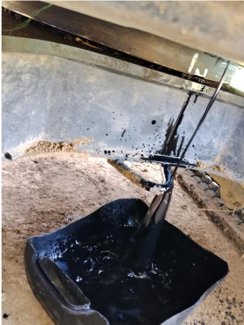
DRENADO DE ACEITE DE MOTOR
