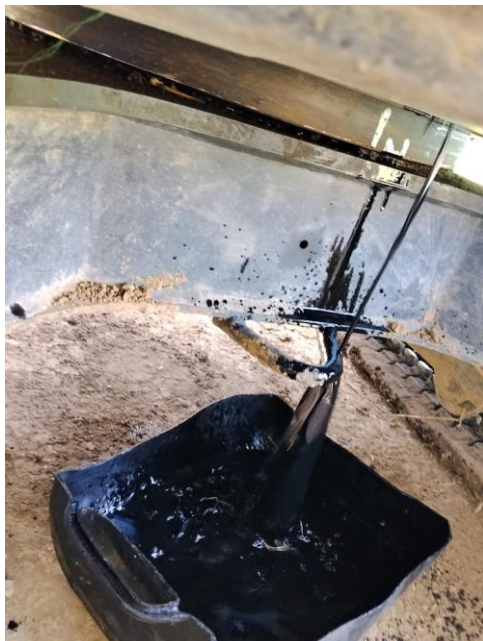
DRENADO DE ACEITE DE MOTOR
