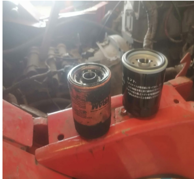
REEMPLAZO DE FILTRO DE ACEITE DE TRANSMISION
