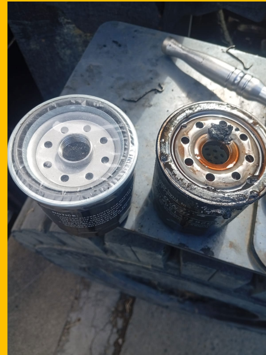
REEMPLAZO DE FILTRO DE ACEITE DE TRANSMISION
