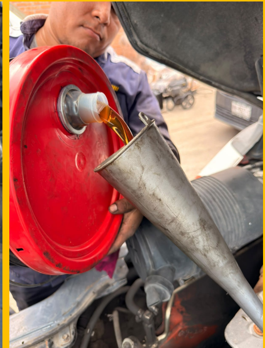
REEMPLAZO DE ACEITE DE MOTOR
