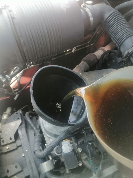
REEMPLAZO DE ACEITE DE MOTOR
