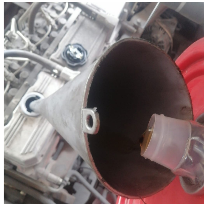
REEMPLAZO DE ACEITE DE MOTOR
