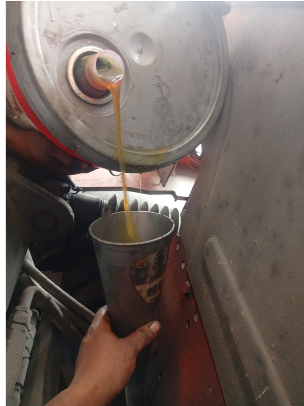
REEMPLAZO DE ACEITE DE DIFERENCIAL
