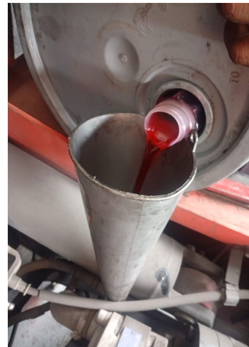
REEMPLAZO DE ACEITE DE TRANSMISION
