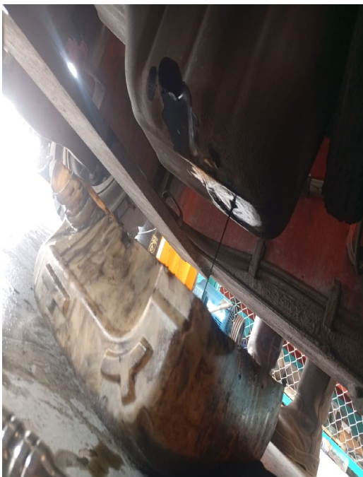
DRENADO DE ACEITE DE MOTOR
