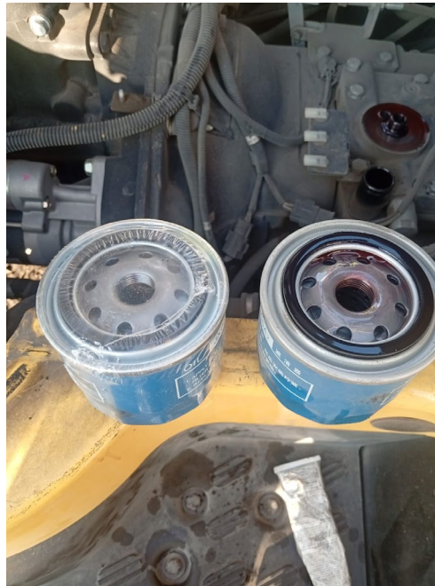
REEMPLAZO DE FILTRO DE ACEITE DE TRANSMISION
