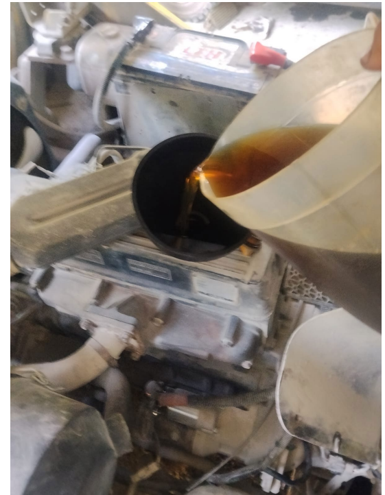
REEMPLAZO DE ACEITE DE MOTOR
