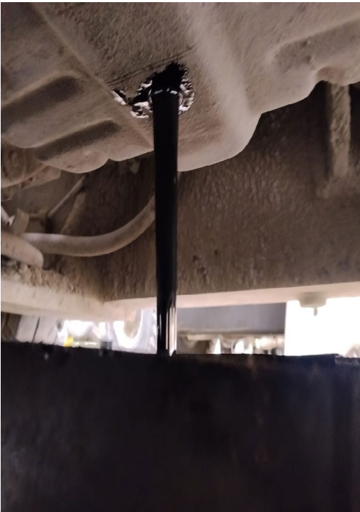
DRENADO DE ACEITE DE MOTOR
