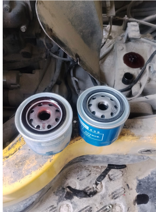
REEMPLAZO DE FILTRO DE ACEITE DE TRANSMISION
