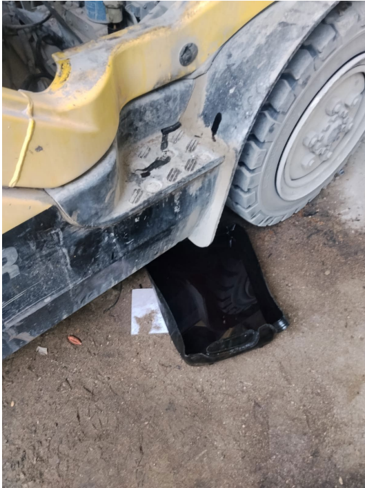
DRENADO DE ACEITE DE TRANSMISION
