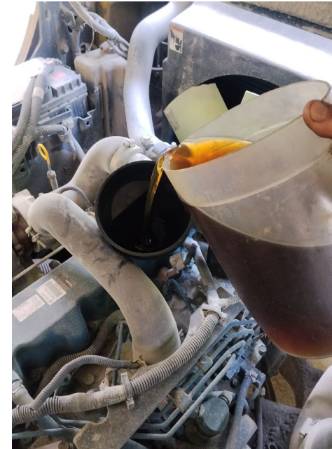
REEMPLAZO DE ACEITE DE MOTOR
