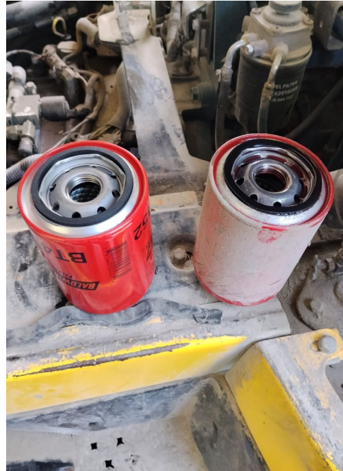
REEMPLAZO DE FILTRO DE ACEITE DE TRANSMISION
