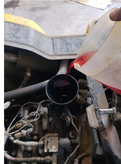
REEMPLAZO DE ACEITE DE TRANSMISION
