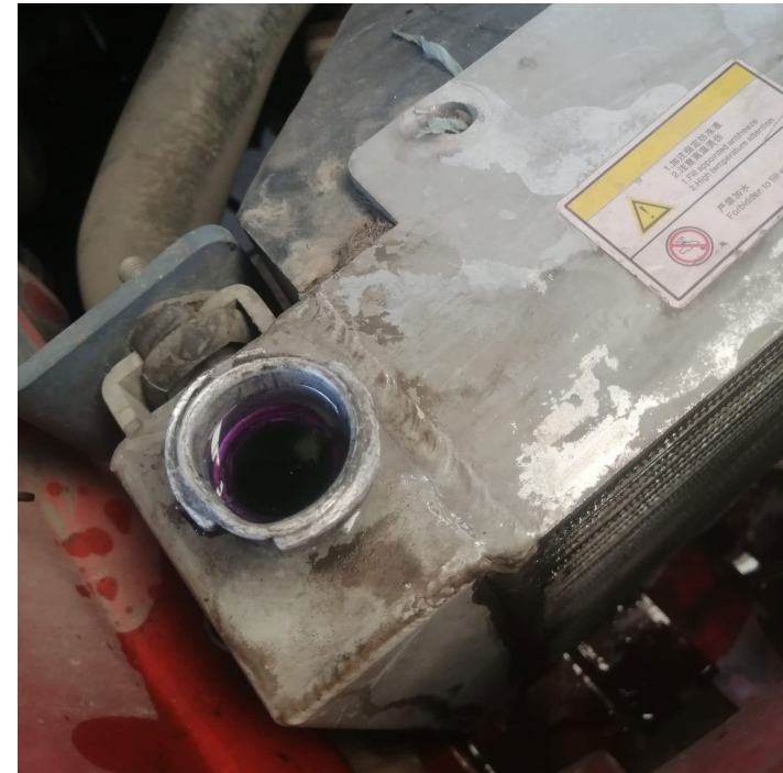
NIVELADO DE ANTICONGELANTE SUMINISTRADO CORRECTO
