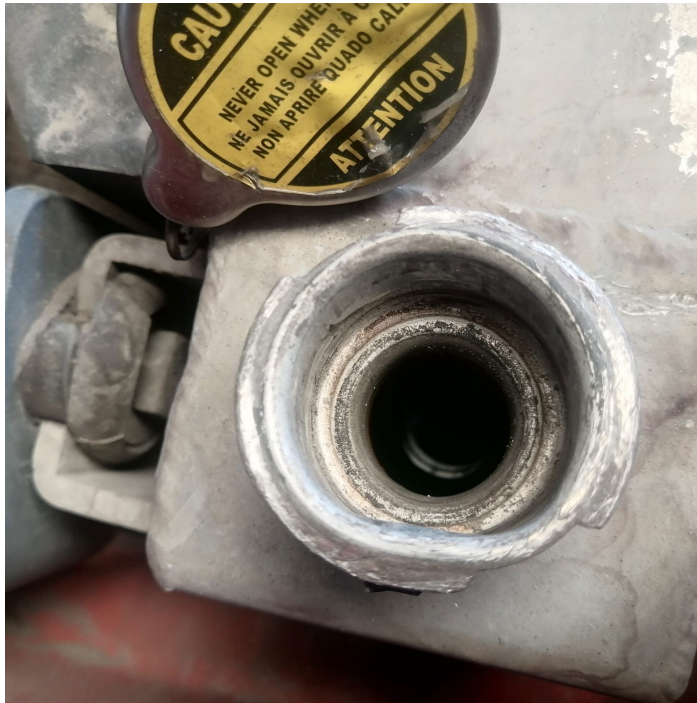
NIVELADO DE ANTICONGELANTE EN BAJO NIVEL ANTES DEL SUINISTRO
