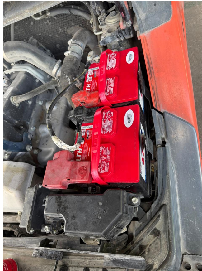
REEMPLAZO DE 2 BATERIA INSTALADO
