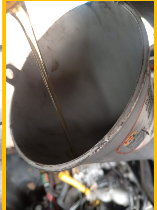
REEMPLAZO DE ACEITE DE MOTOR
