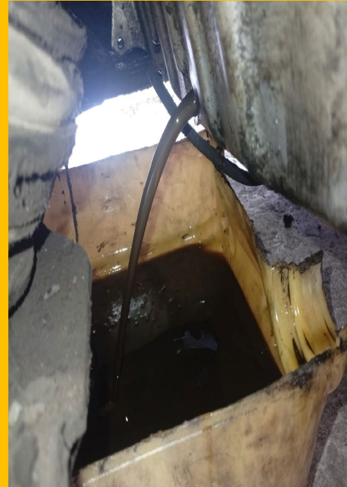
DRENADO DE ACEITE DE MOTOR
