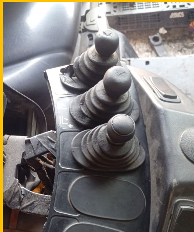
JOYSTICK' S DAÑADOS
