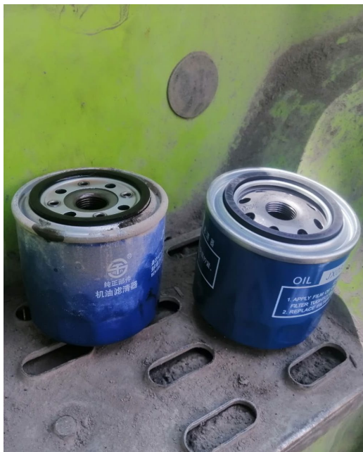
REEMPLAZO DE FILTRO DE ACEITE DE TRANSMISION
