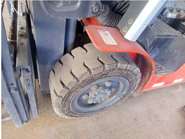
DESGASTE DE LLANTAS POR EL USO OPERATIVO DEL EQUIPO
