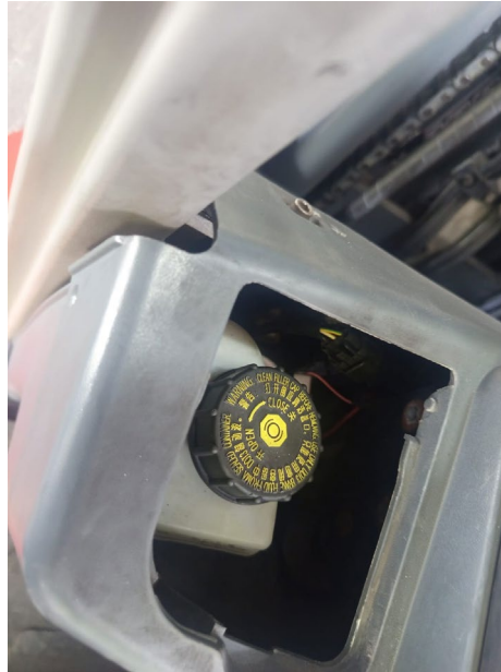
FALTA TAPA DE CUBIERTA DE LIQUIDO DE FRENOS
