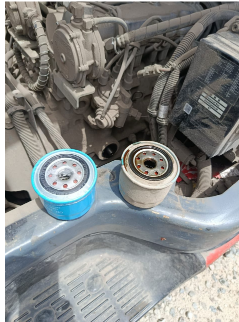
REEMPLAZO DE FILTRO DE ACEITE DE TRANSMISION
