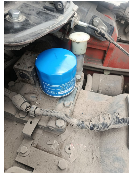
FILTRO DE ACEITE DE TRANSMISION INSTALADO
