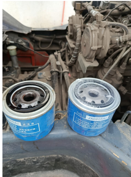
REEMPLAZO DE FILTRO DE ACEITE DE TRANSMISION
