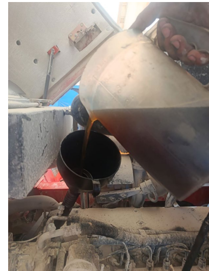
REEMPLAZO DE ACEITE DE MOTOR
