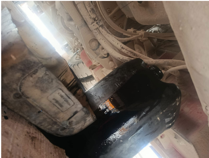
DRENADO DE ACEITE DE MOTOR
