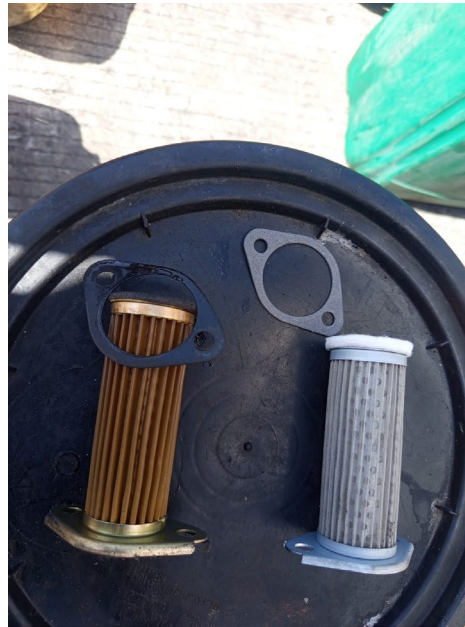
REEMPLAZO DE FILTRO DE ACEITE DE TRANSMISION
