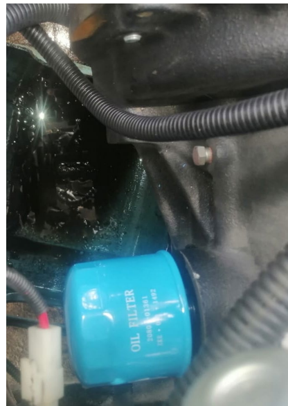
FILTRO ACEITE DE MOTOR INSTALADO
