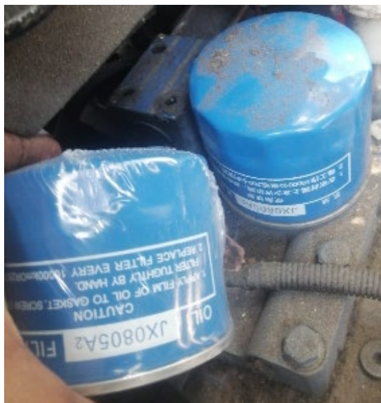
REEMPLAZO DE FILTRO DE ACEITE DE TRANSMISION
