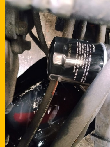
FILTRO DE ACEITE DE MOTOR INSTALADO
