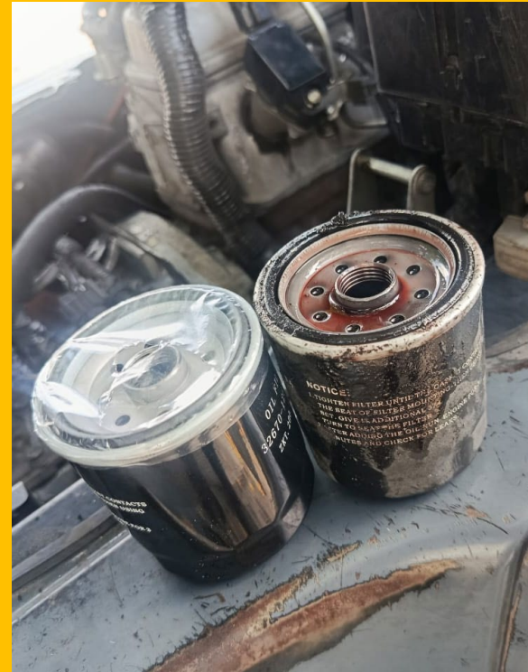
REEMPLAZO DE FILTRO DE ACEITE DE TRANSMISION
