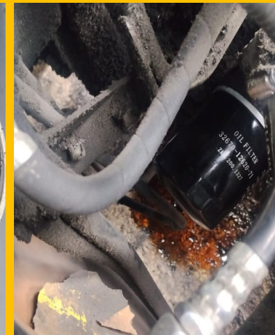
FILTRO DE ACEITE DE MOTOR INSTALADO
