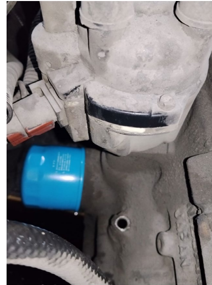
FILTRO ACEITE DE MOTOR INSTALADO
