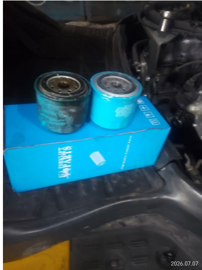
REEMPLAZO DE FILTRO DE ACEITE DE MOTOR
