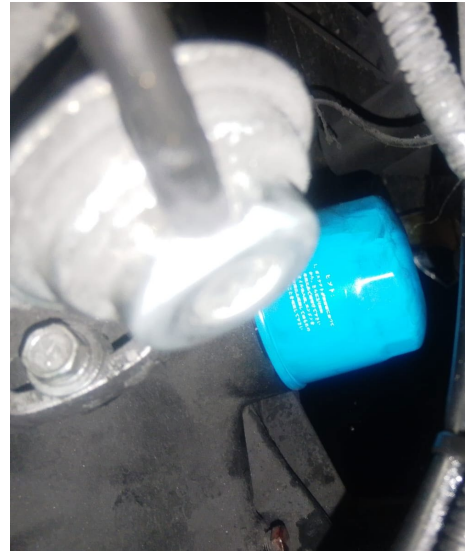
FILTRO DE ACEITE DE MOTOR INSTALADO
