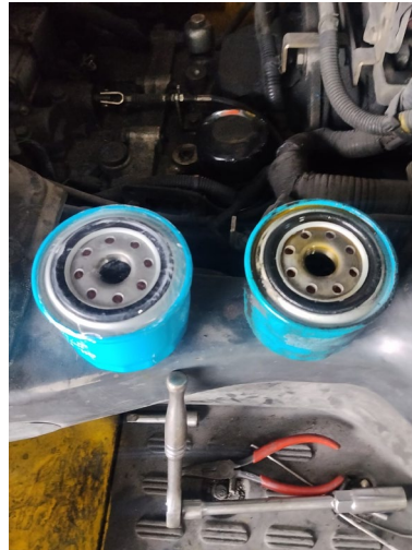
REEMPLAZO DE FILTRO DE ACEITE DE MOTOR
