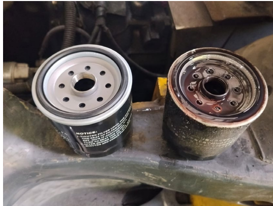
REEMPLAZO DE FILTRO DE ACEITE DE TRANSMISION
