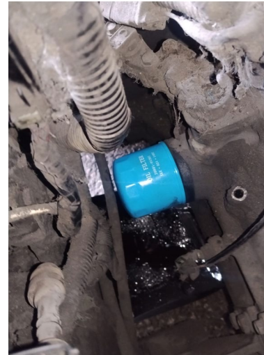
FILTRO DE ACEITE DE MOTOR INSTALADO
