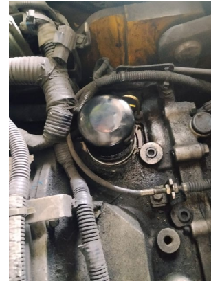
FILTRO DE ACEITE DE TRANSMISION INSTALADO
