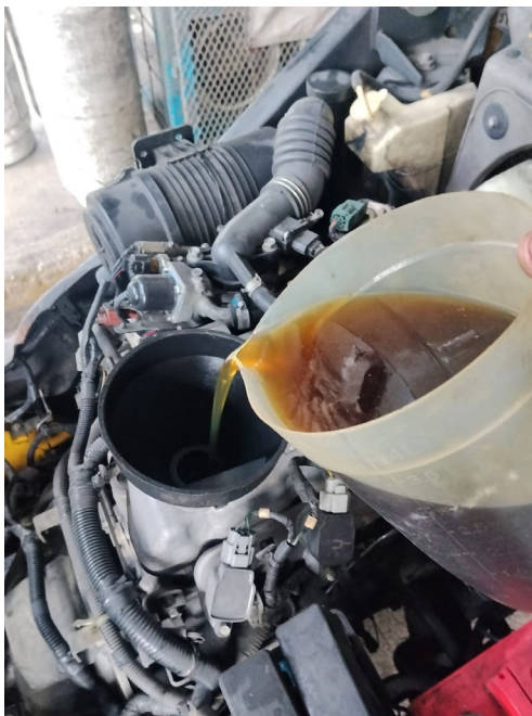
SUMINISTRO DE ACEITE DE MOTOR
