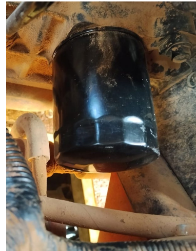
FILTRO DE ACEITE DE MOTOR INSTALADO
