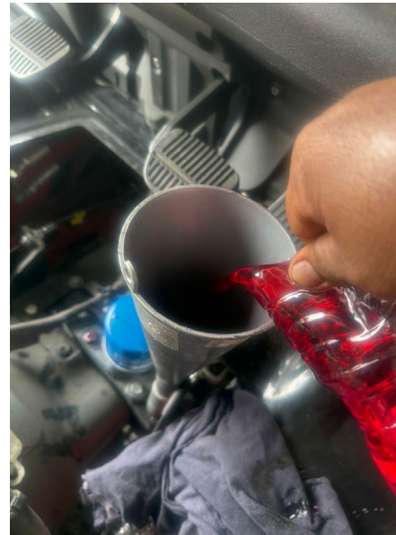
SUMINISTRO DE ACEITE DE TRANSMISION
