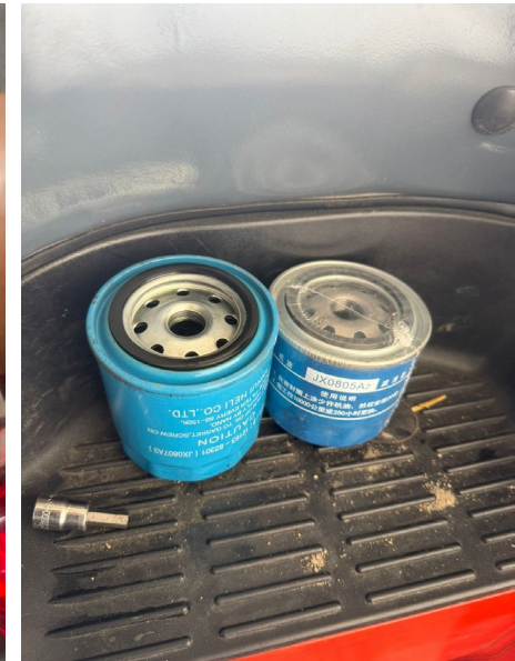
REEMPLAZO DE FILTRO DE ACEITE DE TRANSMISION
