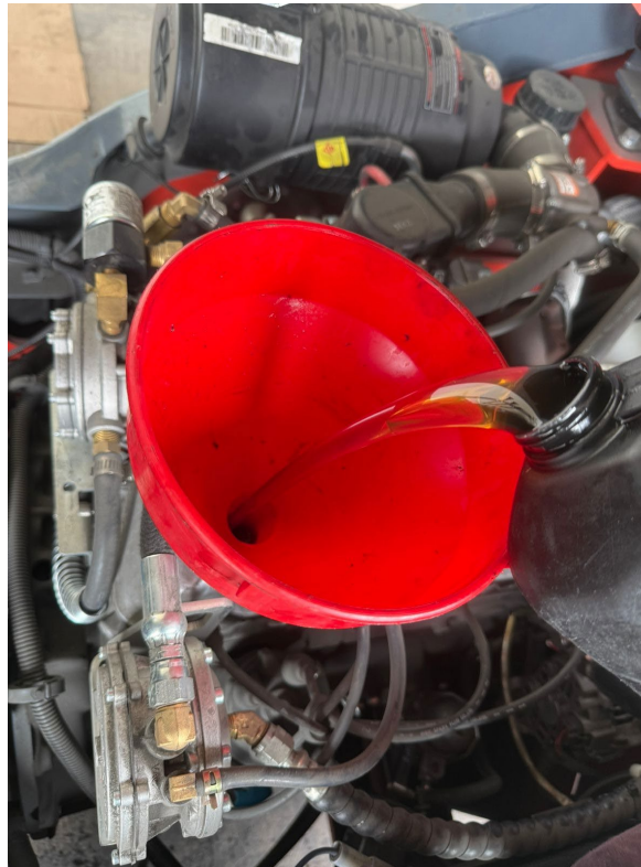
SUMINISTRO DE ACEITE DE MOTOR
