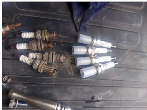
REEMPLAZO DE BUJÍAS
