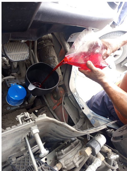
SUMINISTRO DE ACEITE TRANSMISION
