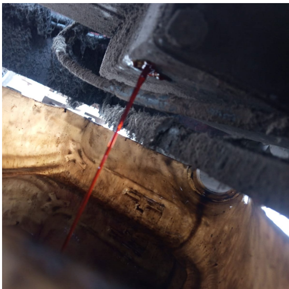
DRENADO DE ACEITE TRANSMISION
