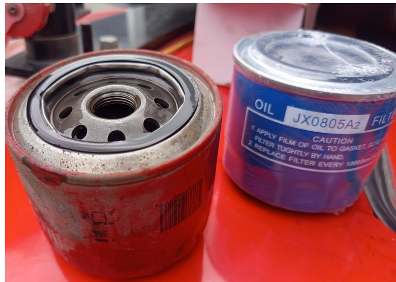
REEMPLAZO DE FILTRO DE ACEITE TRANSMISION
