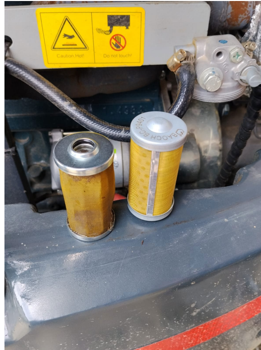
REEMPLAZO DE FILTRO DE COMBUSTIBLE DE SEPARADOR DE AGUA
