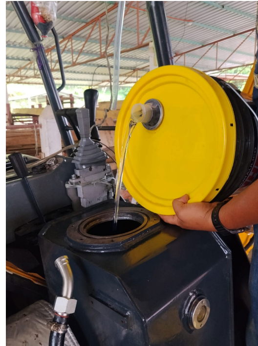
SUMINISTRO DE ACEITE HIDRAULICO
