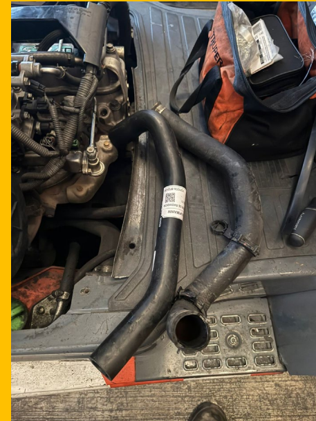
REEMPLAZO DE MANGUERA SUPERIOR DE RADIADOR
