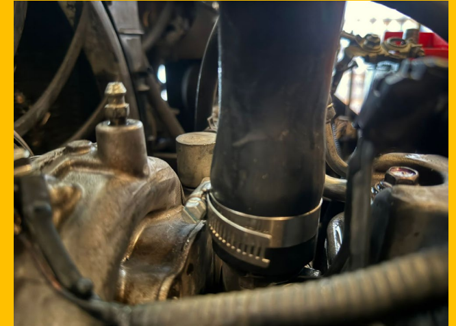
ABRAZADERAS DE MANGUERA INSTALADAS
