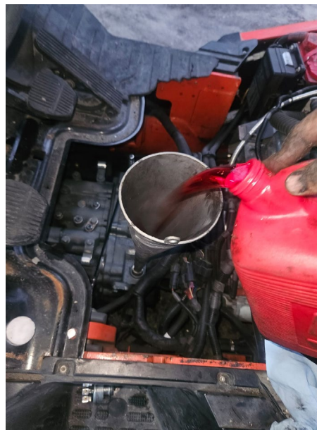
SUMINISTRO DE ACEITE DE TRANSMISIÓN
