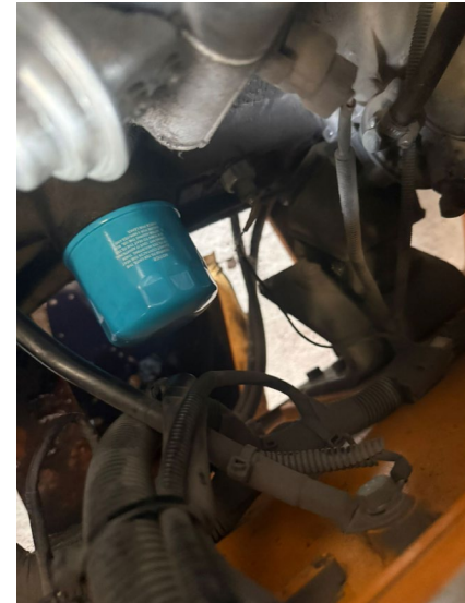
FILTRO ACEITE DE MOTOR INSTALADO
