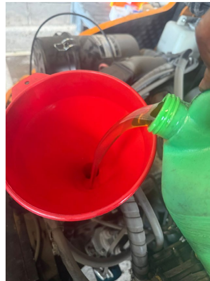
SUMINISTRO DE ACEITE DE MOTOR
