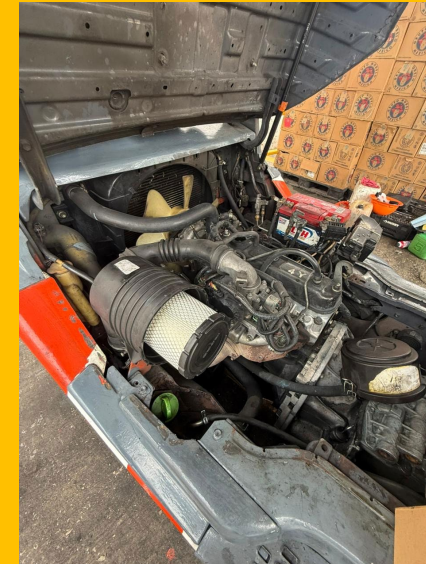
INSTALACIÓN DE FILTRO DE AIRE
