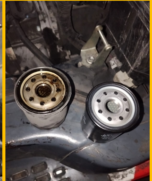
REEMPLAZO DE FILTRO
