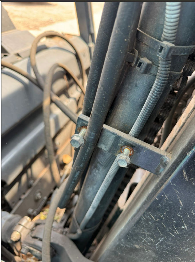
NO CUENTA CON BASE PARA MANGUERAS DE CILINDROS DE LEVANTE LATERAL
