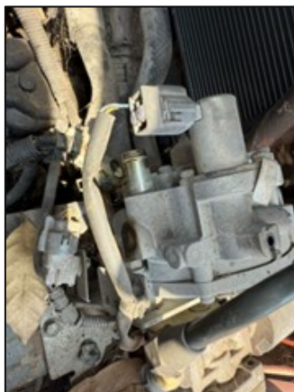
NO CUENTA CON MANGUERA DE VAPORIZADOR DE GAS
