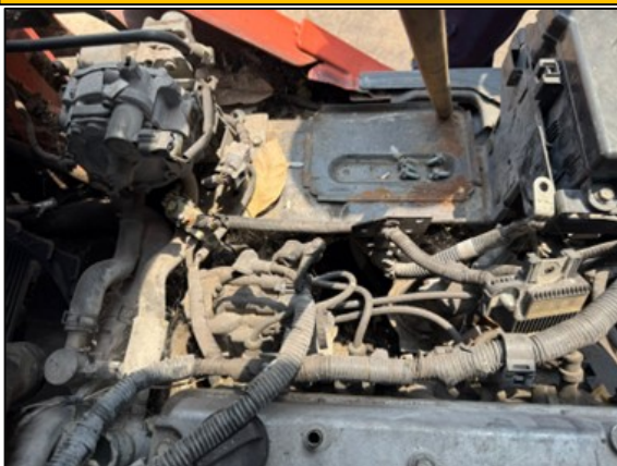
NO CUENTA CON MANGUERA DE VAPORIZADOR DE GAS
