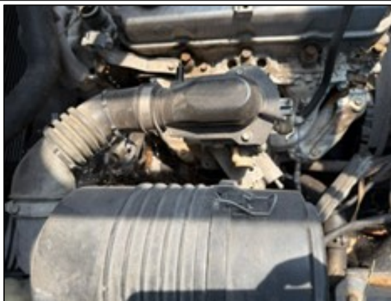
CONECTOR "AIR CLEANER" EN MALAS CONDICIONES – SIN MANTENIMIENTO
