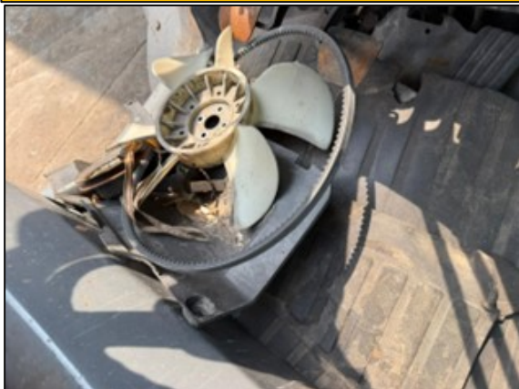
BOMBA DE AGUA INHABILITADA Y EN MALAS CONDICIONES
