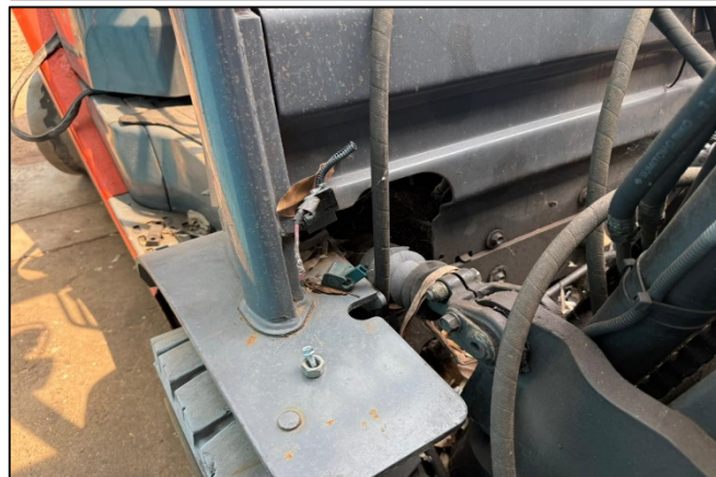
CABLES DESCONECTADO Y PALANCA DE FRENO DE MANO FUERA DE LUGAR
