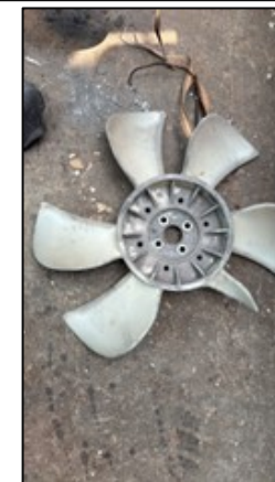
VENTILADOR DEL RADIADOR QUEBRADO
