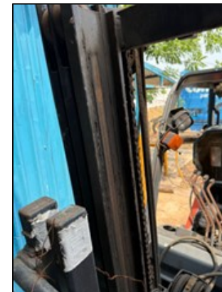
FALTA DE MANTENIMIENTO EN SECCIONES DE MÁSTIL
