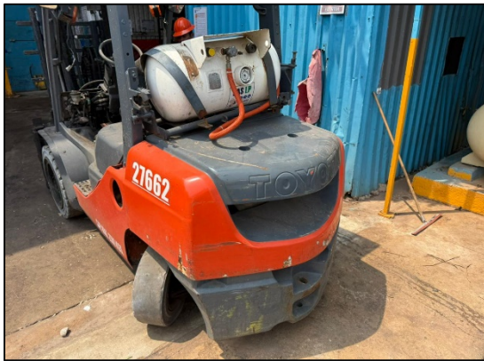
TANQUE DE GAS ADAPTADO
