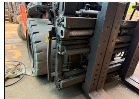
FALTA DE MANTENIMIENTO EN CILINDRO DE APERTURA
