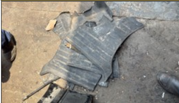
CONECTOR "AIR CLEANER" EN MALAS CONDICIONES – SIN MANTENIMIENTO
