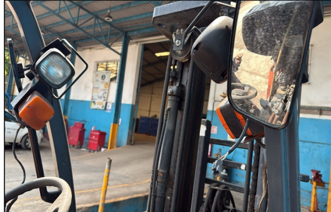
CABLES DESCONECTADO Y PALANCA DE FRENO DE MANO FUERA DE LUGAR
