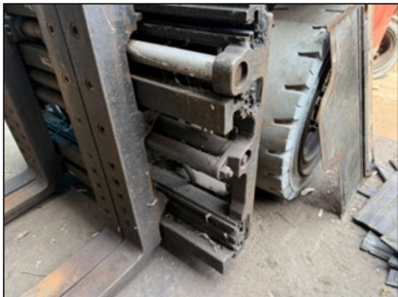
FUGA Y FALTA DE MANTENIMIENTO EN CILINDROS DE ADITAMENTO
